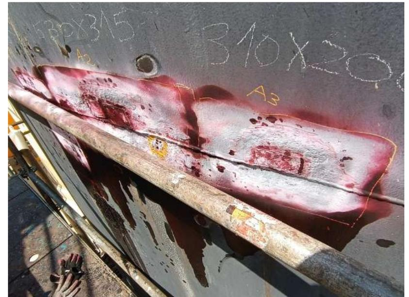
◆ *Aplicación de ensayo no destructivo*
